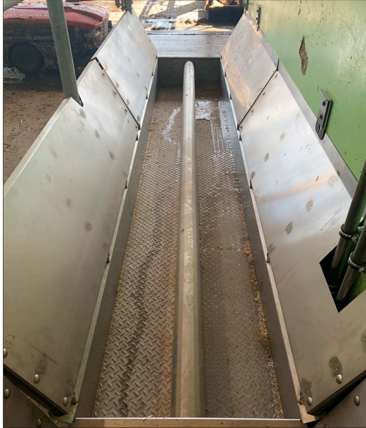
Das Klauenbad mit einem Gefälle von 3 Prozent zum Abfluss hin. (Bilder: zvg)
